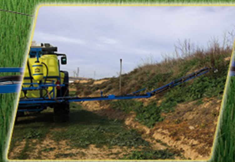
Media geometría variable que posibilita el tratamiento en taludes.
