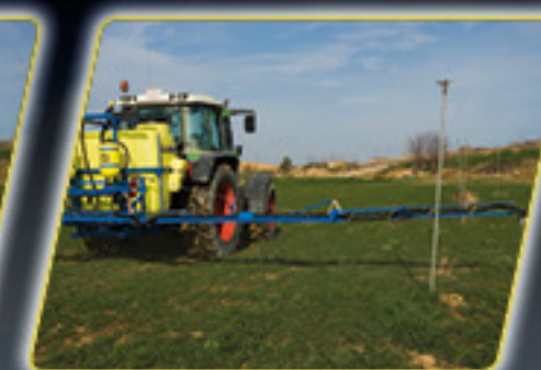
Puntas de barra con dispositivos de seguridad anti-rotura.
