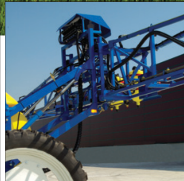
Barra de 24 mts. tipo 7 TR. Se puede elevar para tratamiento de los cultivos más altos.
