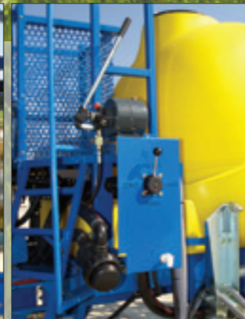
Freno de estacionamiento hidráulico.
