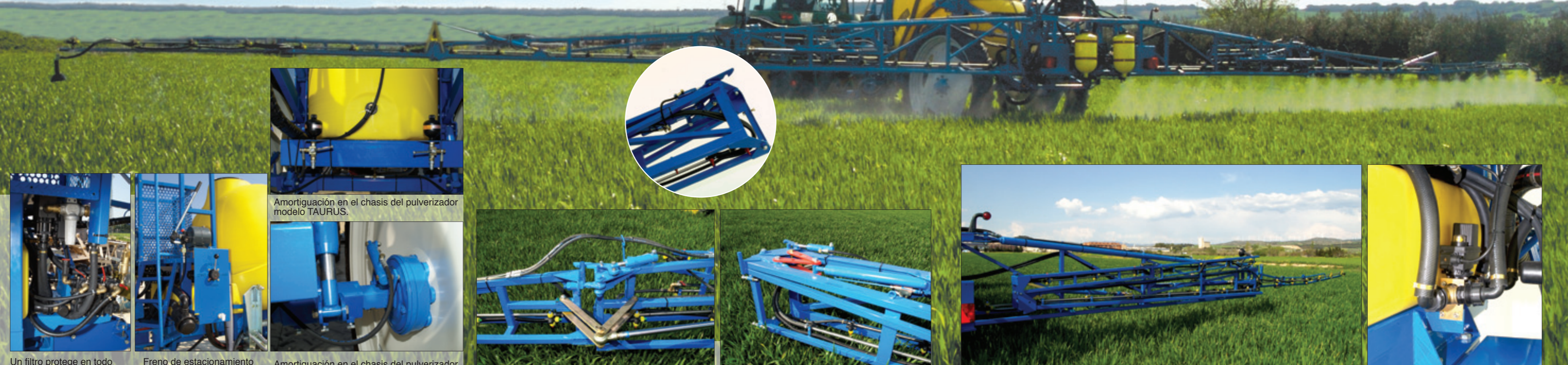
Sistema de bloqueo que asegura una estabilidad permanente en las barras (5 TR y 7 TR) incluso en suelos irregulares permitiendo una pulverización precisa y uniforme en todo el campo.
