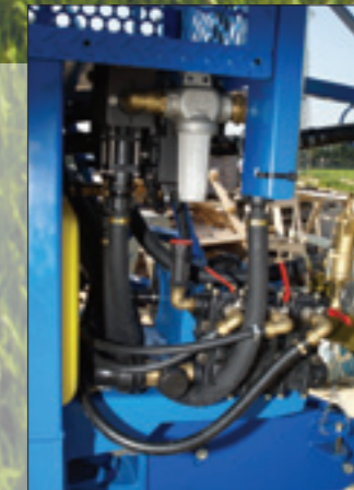
Un filtro protege en todo momento el funcionamiento y la fiabilidad de los mecanismos de control del pulverizador.
