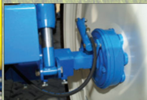
Amortiguación en el chasis del pulverizador modelo NORMA. Este tipo de suspensión otorga gran estabilidad a todo el conjunto chasis-barra pulverizadora.
