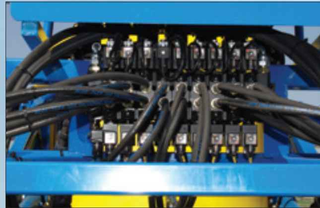
Por medio de un distribuidor eléctrico podemos actuar sobre todas las funciones mecánicas de nuestra barra.
