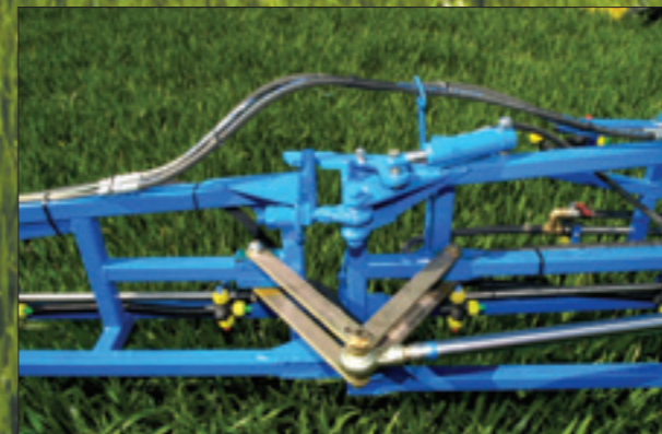
Sistema de bloqueo que asegura una estabilidad permanente en las barras (5 TR y 7 TR) incluso en suelos irregulares permitiendo una pulverización precisa y uniforme en todo el campo.
