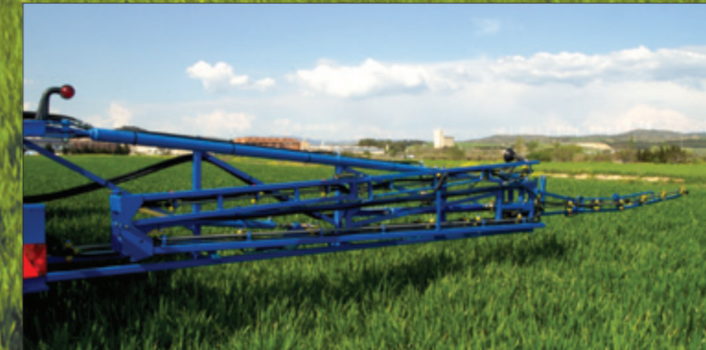
La barra tipo 7 TR de 24 mts. puede incorporar la posibilidad de trabajo a 15 mts con una adaptación hidráulica especial.
