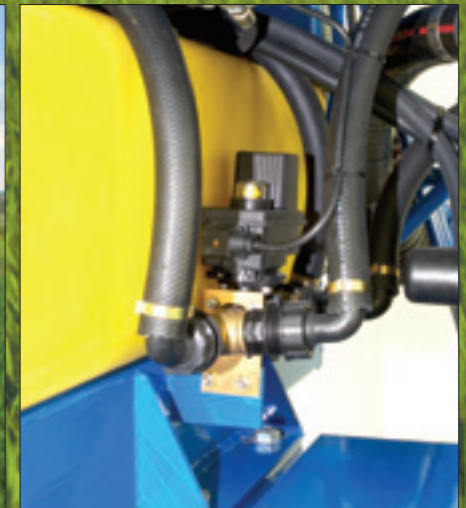
Válvula de regulación. Elemento fundamental para conseguir la mayor precisión en la distribución de la dosis programada.
