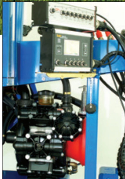
Bomba de membranas de 250 lts/min. que permite tratamientos de altas dosis de litros por hectárea. Todos los mandos del pulverizador – circuito de agua e hidráulico - van en la cabina. El pulverizador dispone de un soporte para su guardado cuando la máquina no trabaja. Todas las conexiones están protegidas a fin de alargar la vida útil de los componentes.
