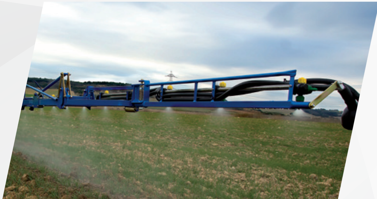
La estructura de la barra protege todo el circuito de alimentación de las boquillas
