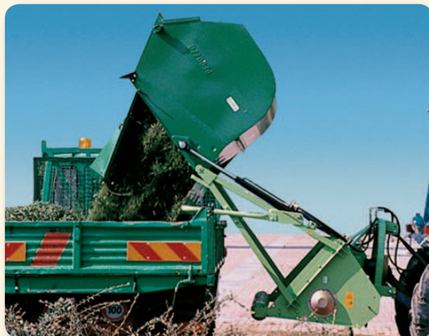
Scarico idraulico fino a 2 mt di altezza tramite il sollevatore del trattore. Hydraulic high tip discharge up to 2 mt. by means of tractor lift. Bennage hydraulique du coffre de ramassage jusqu'à 2 m de hauteur avec l'aide du relevage du tracteur. Hydraulischen Kippvorrichtung des Behälters, der mit Hilfe des hydraulischen Hebwerke des Traktors bis zu 2 Meter hoch gekippt werden kann.
