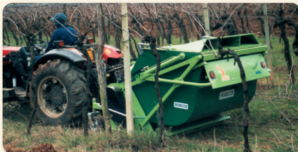
Triturazione di potature nei vigneti o frutteti con raccolta. Pruning shredding and collection on vineyards and orchards. Broyage et ramassage de sarments de vigne et d'arbres fruitiers. Mulchen und Aufnehmen von Schnittgut in z.B. Weinbergen und Obstgärten.
