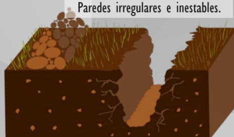
El material extraído no se puede utilizar como relleno sin triturarlo previamente, o bien es necesario retirarlo, siendo necesaria la aportación de material nuevo.
