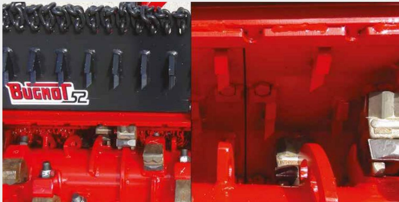
Para un triturado óptimo, la trituradora está equipada con contraplacas, con retenedores o rompedores en la parte superior del rotor y en la puerta trasera
