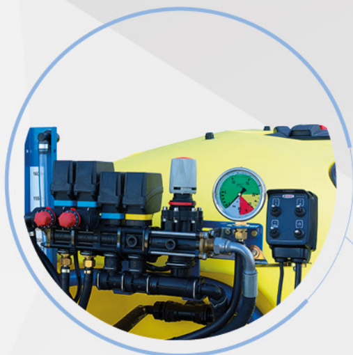
Válvula motorizada con regulación de la presión desde la cabina.
