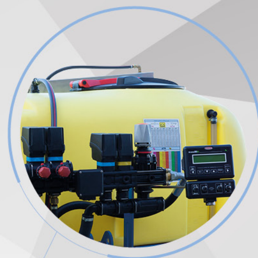
Válvulas motorizadas con control electrónico de caudal proporcional al avance.
