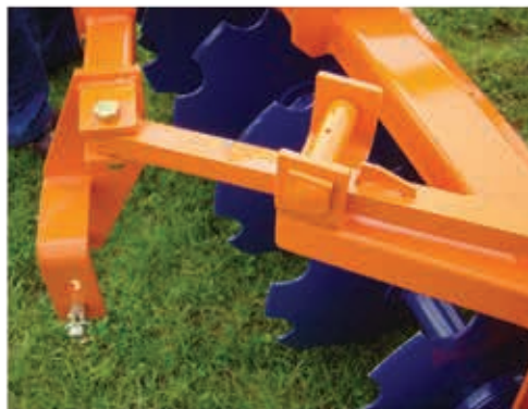
Tirante de apoio dos corpos de discos Tirant support des corps des disques Disc gangs connecting-rod support.
